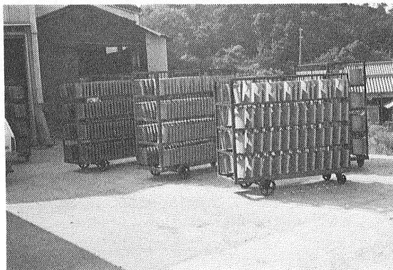
写真16 兵庫県・淡路瓦 成形後の天日乾燥(兵庫県五色町産業課提供)
