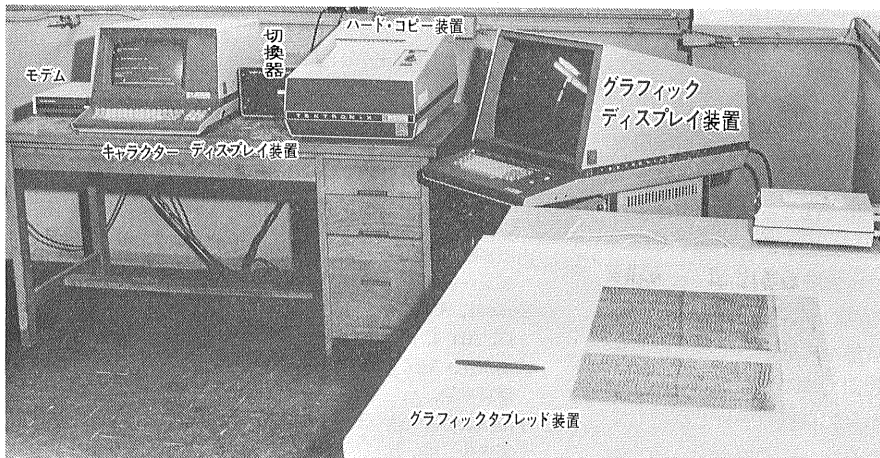
図1 グラフィック・ディスプレイのハードウェアシステム図
