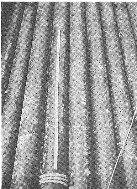
① 4 1/2"ケーシングパイプ(ストレーナー部)
