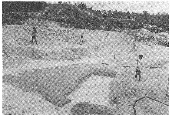
写真16 カオリン露天採掘現場。放水してカオリン泥流をポンプで水洗場に吸み上げる
