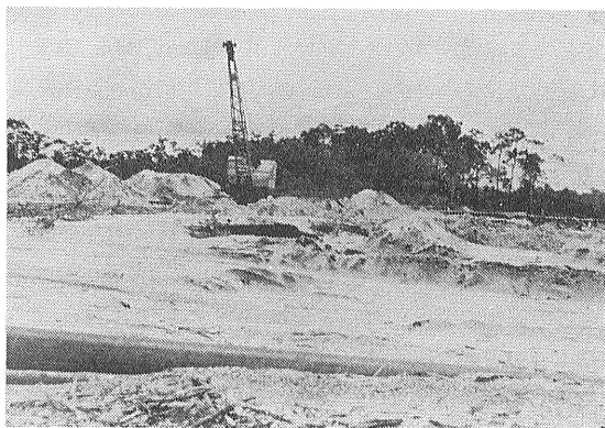
写真9 ピリトン島の内地。黒雲母花崗岩地帯を流れるRajah川上流のBadau地区砂錫採掘現場。グラベルポンプが稼働したところはカオリン 珪砂が山積している。
