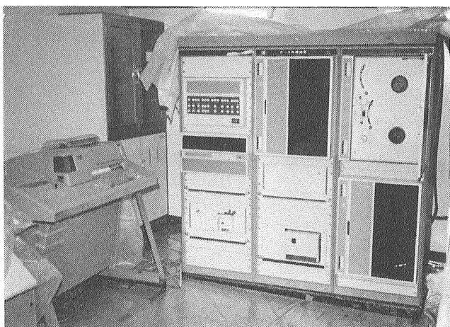
第2図 情報処理装置の外観 中央の3つのコンソールは処理部 左はテレプリンター
