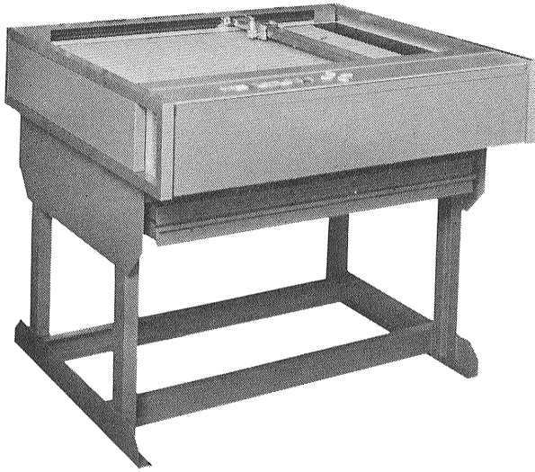
第7図 プロッターの外観 プロッターはデジタルのフラット・ベッド型でAO判(1.1m×0.8m)まで描ける 精度は0.1mm 電算機とオンラインで結ばれている
