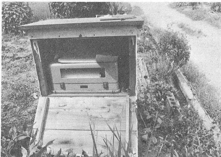
写真1 徳島県阿南市所在の観測井における地下水位観測用横型ドラム式自記水位計(7日巻)
