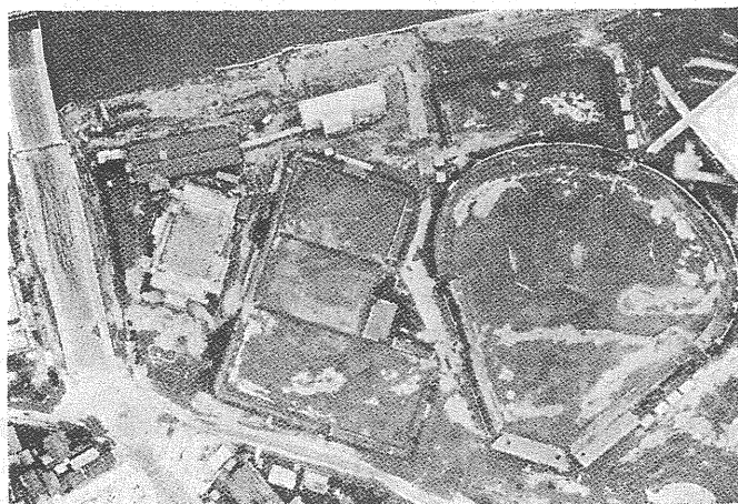
写真③ 昭和大橋・県立競技場付近の新潟地震による地盤破壊状況 (TAKAHASHI et al. 1972)
