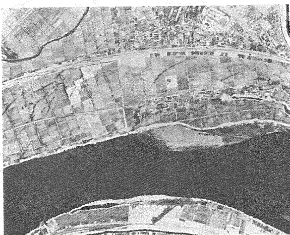
写真④ 信濃川堤防付近の新潟地震による地割れ、赤外線写真 (TAKAHASHI et al. 1972)
