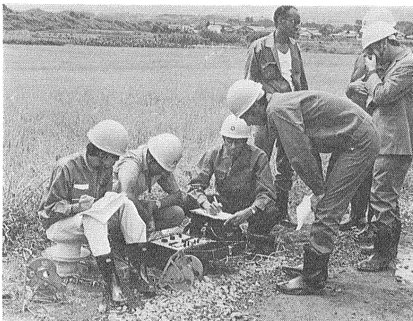
地下水探査のため電気探査実習中の研修員(地下水開発コース)
