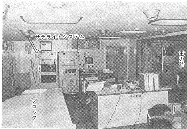
第23図 人工衛星測量システム 写真の右端部に船上重力計がある
