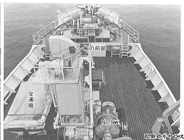
第27図 船楼甲板前部 左舷側より 交通艇 2Tクレーン No.3ウインチ ギヤロス がおかれている
