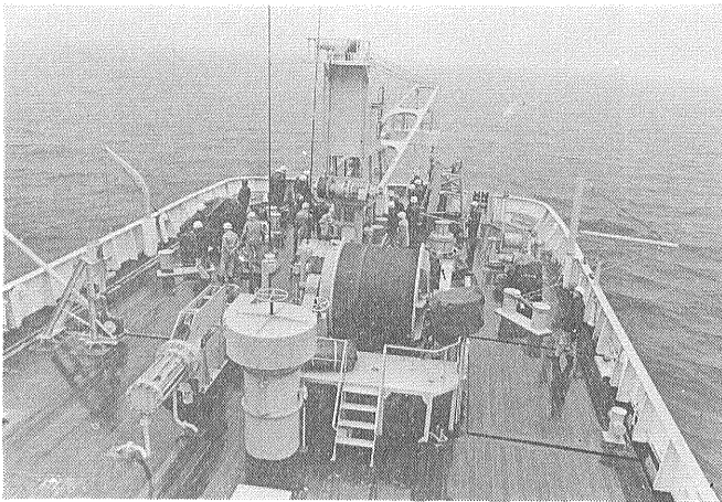
第28図 後部作業甲板 中央右側にある のがNo.4 ウィン チ
