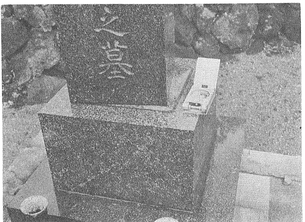
写真④ 墓石の変化。竿石が反時計まわりの回転を示している。クリノメーターの長辺はN15°Eを示す。供養桶付近にて (1972年12月15日撮影)
