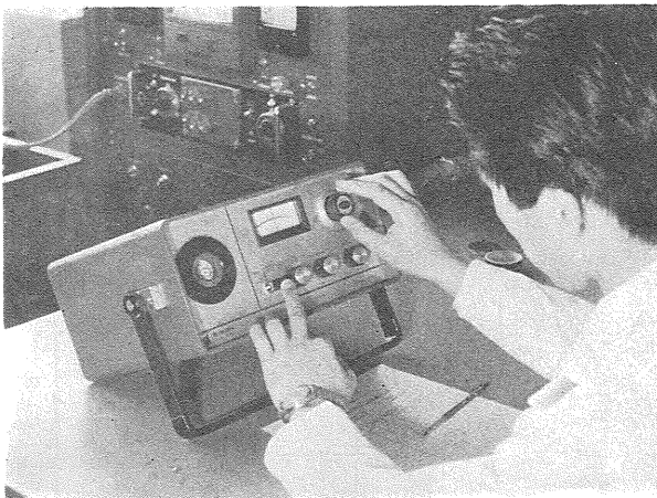
写真① Bison 3101A 磁化率計 固体試料 (1"φ×2.5") をプラスチックケースにいれ 内部コイルで測定している
