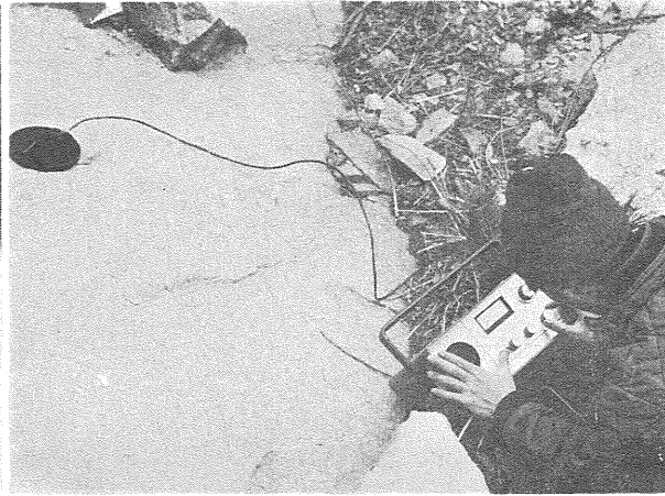
写真② 磁化率の現地測定 フラット・コイルを露岩にあて磁化率を測定している 対象は阿武隈山地 宮本岩体の花崗岩 (撮影 滝沢技官)
