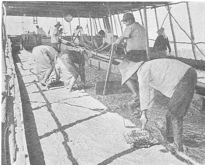
選鉱場の内部 鉄線で作ったザルで礫をすくって外にすてる 立っている男は泥水の流速を加減して錫石を沈澱させる
