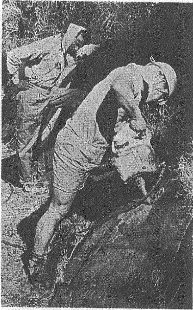
図30 ガソリンエンジン・ドリルで古地磁気学的研究用の方位試料採集
