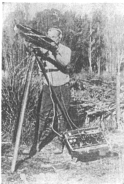
図7 初期の電磁法探査装置の一種（受信部）オーストラリアで1930年頃使用されたもの
