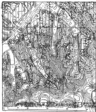
第11図 川崎市飯室付近地質図 泥層・砂礫層の上に1m~2m新期ロームが不整合に堆積しているが 新期ロームはのぞいてある
