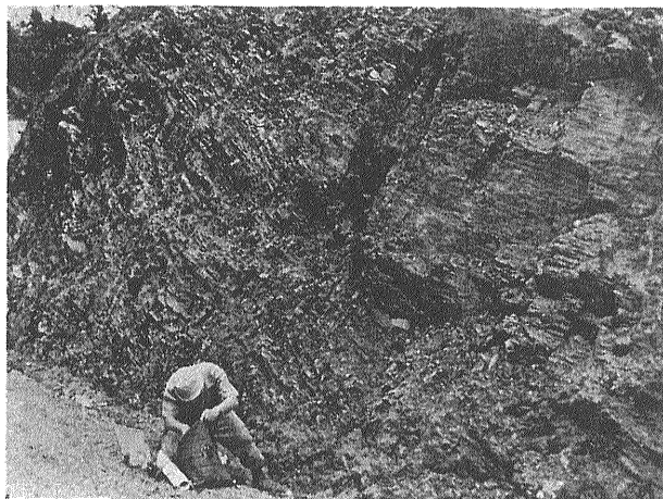
泥質片岩の風化岩盤 地すべり上部の新道 cutting ぼろぼろに風化した絹雲母片岩の岩盤からなり、局部的に粘土化した部分を夾んでいる。下部（河岸）の崖錐堆積物は地すべりをおこしている。
