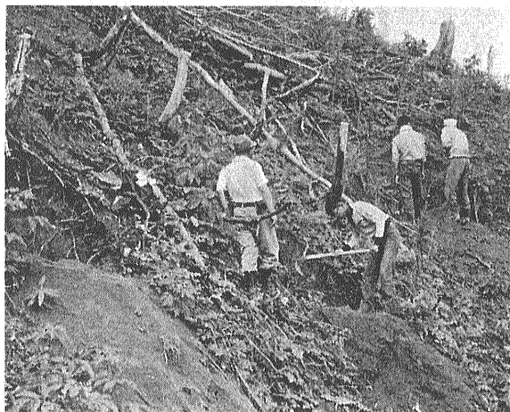
異常点付近のトレンチ作業 表土をとり除いて 花崗閃緑岩と堆積 岩との境界をたねんに追跡して行く 楽な仕事ではないが このよ うに岩石の露出がわるい地域では 欠かせない作業である。
