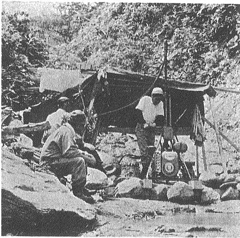
異常点と基盤岩の関係を正確につかみたいときには 試錐でたしかめねばならない 河原の転石には 大きな花崗閃緑岩のブロックがまじり 近くに基盤岩が露出していることを暗示している。(良留石川異常点付近)
