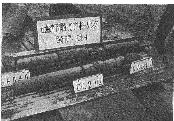
第VI-22図 大阪府が尼崎市戸ノ内地内で実施した700m試錐のコア
