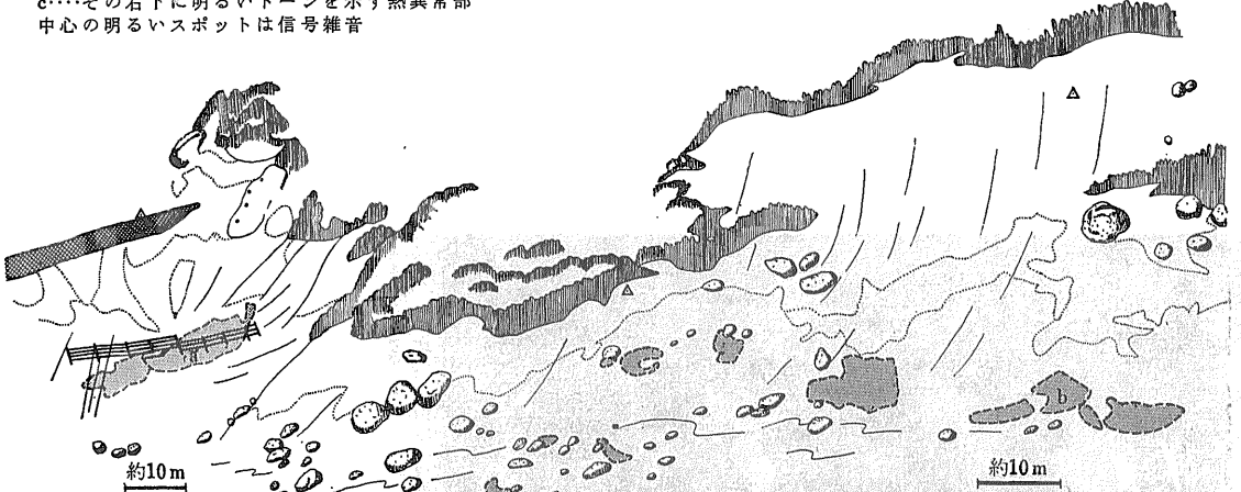
第4図b 那須殺生石赤外線撮影地のスケッチ [(第4図a)の左半分から右半分の左端までの範囲] 点線は地質区分境界 地質区分は省略 網地は探知された温度異常の範囲を示す a点付近の最高温度96°C b点付近の最高温度35.2°C (測定: 1966年2月25日曇り 午後5時15分~40分の間)
