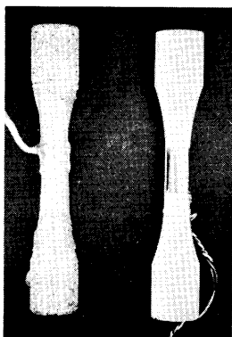
第5図 第6図の試験機に使つた試料。普通の円筒形だと上下のアナ板との間の接触部の影響がたえず問題となる。これを防ぐため、Braceはこのような独特の形を考案した。
