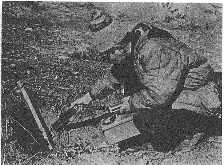
携帯用シンチレーション DC-P5型で放射能異常を測定する 岐阜県土岐市西山日吉神社うらの露頭(放射能強度15~60倍 層厚約1m 露頭延長約100m 花)
