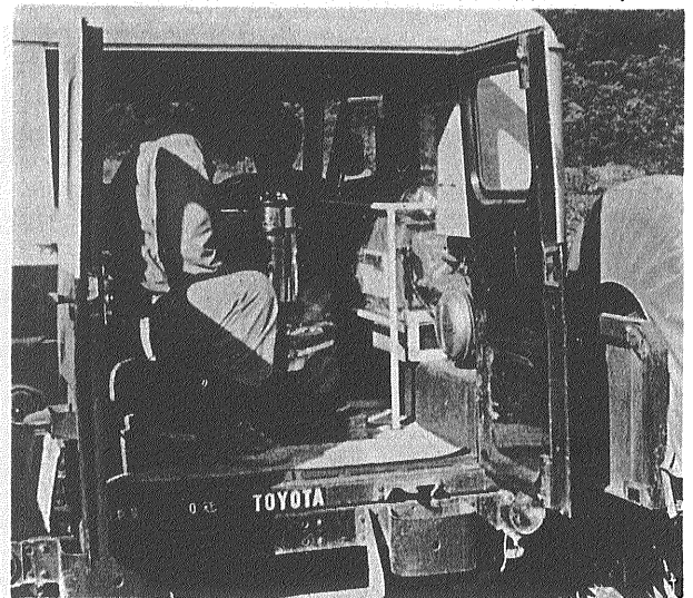
冷暖房のついた重力測定車(金属広域調査)
