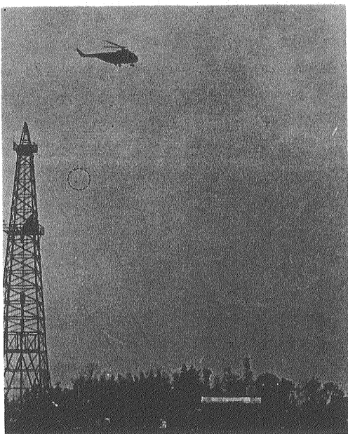
空中磁気探査(点線内の黒点はブイ)
