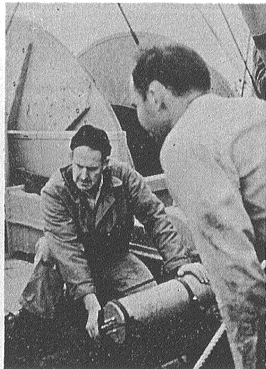
Dr. John Ewing と海底地震計 大西洋のバーミューダ島付近で 5000m の海底に地震計を下ろす 深海でそこを伝わる地震波動を観測し、その伝播の様相を調べたり陸上では観測にかからない地震を検出したりすることが目的である。観測時間は10日位で内蔵するフィルムに記録する。刻時は1日1秒程度の誤差の時計でマークを入れる。観測船はサー・ホーレス号 後方のドラムには10,000mのロープが巻いてある
