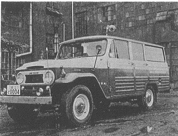
地化学探鉱車(ジープ): フィールド調査用でこの車に小型ガスクロマトグラフ2台をのせる 屋根の上に 夜間の分析作業用のライトがみえる
