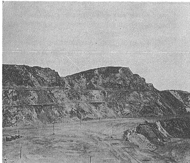
南オーストラリア州 Middleback Ranges 中オーストラリア最大の稼行鉄鉱山である Iron Monarch 鉄床の露天掘 (5段ベンチ) 状況 (年間約270万トン Fe 62%出鉱)
