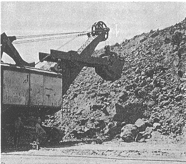
Iron Monarch 鉄鉱床の切羽にて パワーショベルによる採掘状況
