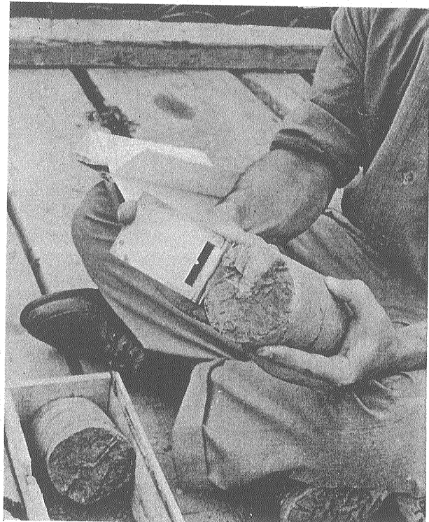
コアに地層の傾斜が認められる場合には クリノメーターを利用して測定する
