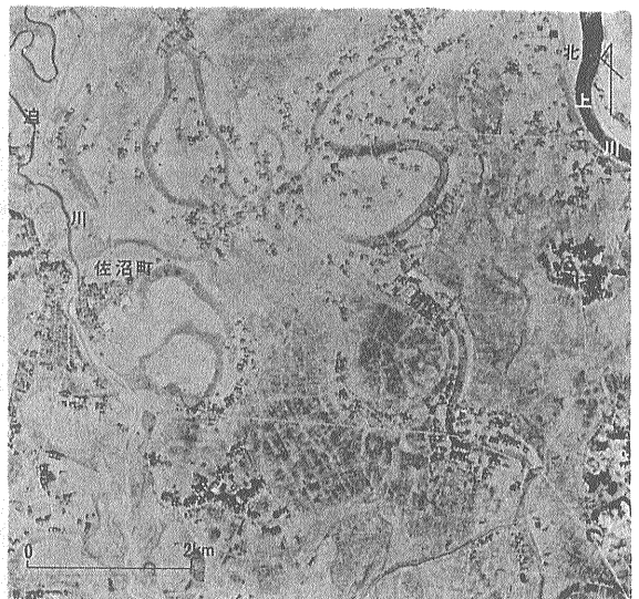
第31図 宮城県登米郡佐沼町付近における沖積氾濫原 旧河床とみられる低湿地三日月湖など古い蛇行の跡が一見して把握できる 水田中暗い階調を示す所は 最近まで低湿地であった所に一致する
