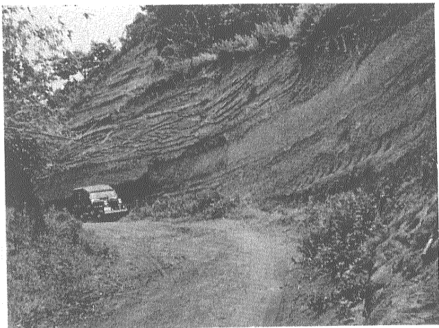
成東層最上部の砂鉄露頭(松尾町南谷) 私たちの砂鉄調査はこの露頭の発見にはじまった 砂鉄の品位は 着磁品位 \left[ \frac{\text{磁石に付着した重さ}}{\text{全体の砂の重さ}} \times 100 \right] は 13%含砂鉄砂層の上には自生型の介化石を含む砂質シルト層がのっている
