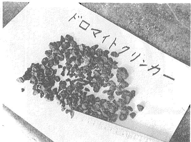
ドロマイトクリンカー 粗砕したドロマイトに鉄粉をまぶしてロータリーキルンで焼成したもの (磐城セメントKK製品)
