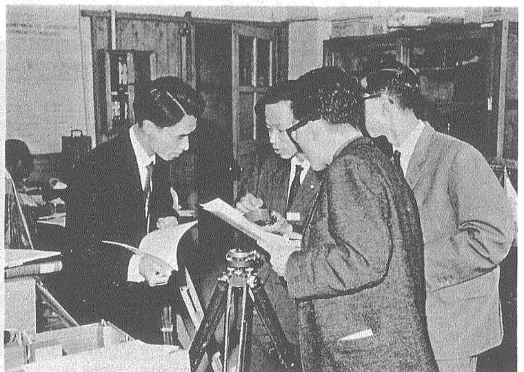
物理探査の実験 (磁力計)
