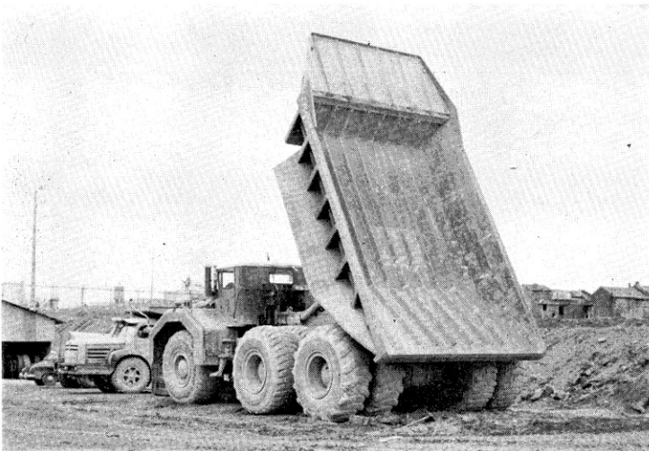
ブ ジ ョ ー 製 700HP ダ ン プ カ ー (100t 積 み)
