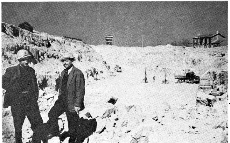
Vendée 地区 La Chapelle Largeau 鉱山露天掘り 遠方は堅坑 ここは "Dedet" 鍾(走向EW 走向延長1km 傾斜60°S)と "Ecole" 鍾(走向NS 走向延長600m 傾斜60°W)の交点で いずれも傾斜延長400m 鍾幅0.5~1m 平均品位1‰Uの鉱床である 人物の左は Leblanc 技手で 1950年にフランス最大の Bois-Noirs- Limouzat 鉱山の鉱床を発見した 現在は Vendée 支所勤務 右は Durand 技師
