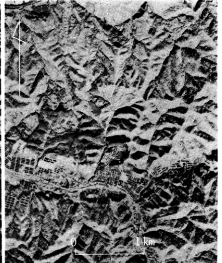
〔第1図版〕塊状泥岩(幌内層)にみられる樹枝状水系模様 岩質が比較的緻密であり谷はV字型 山稜は逆V字型の断面をしている(北海道三笠市幌内)
