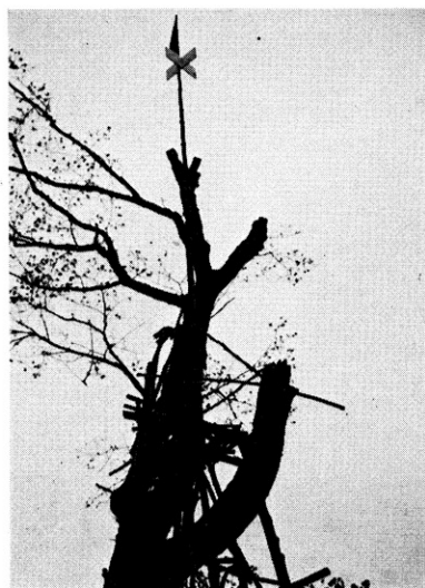
大木を利用した図根点の簡易図標
