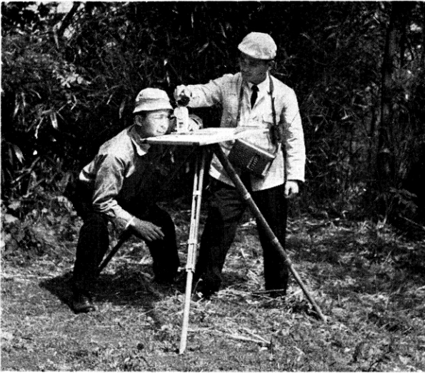
← 既設三角点の利用が困難な場合に 平板で簡易天文測量を行なって方位角を測定する 携帯ラジオは日本標準電波秒報時(JJY)を受信する
