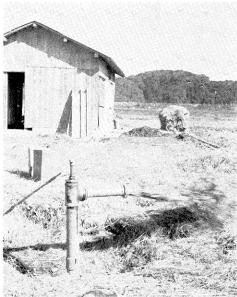
高知県中村市のガス井 (エアリフト試験)
