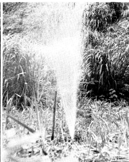
秋田県亀田町地内にある古い試掘井からのガスの自噴
