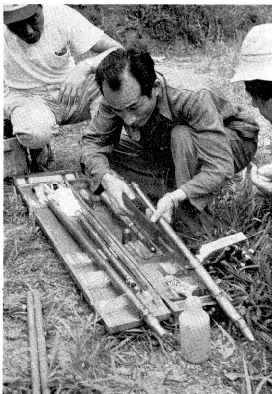
↑ 坑底圧測定器の組立作業
