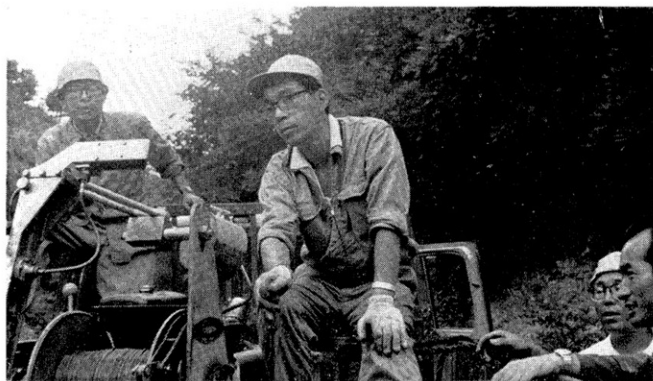
← 坑底圧測定調査の捲揚機 (古河好間新1号井)
