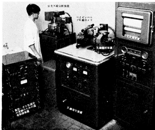
ガイガー計数管 X線分光計（ガイガーフレックス 理学電機製）
