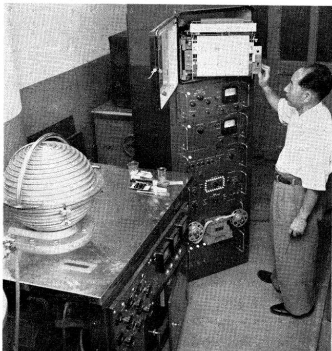
自動式示差熱分析装置 (非金属鉱石の加熱変化を測定し 鉱物の相の変化を調べ また鉱物鑑定にも利用する)
