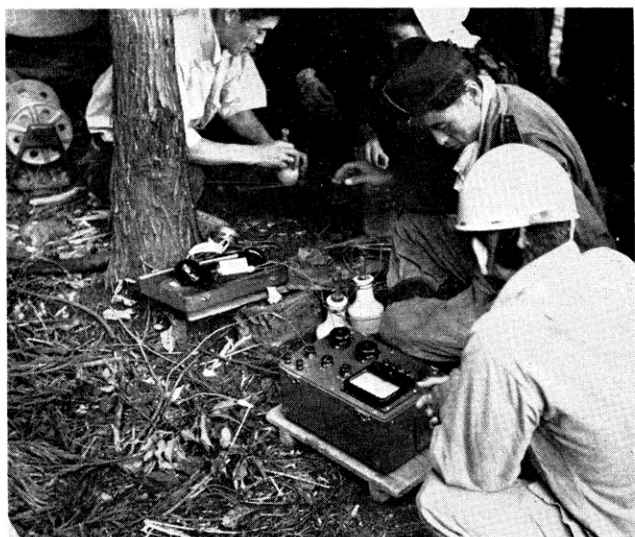
↑ 自然電位法の作業準備 電位差計のそばに見える2つの素焼製のビンの中に硫酸銅の飽和溶液を入れ、非分極性電極として用いる
