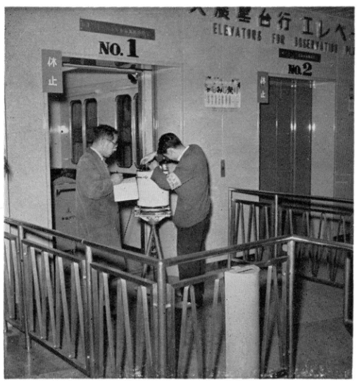
東京タワー昇降口での重力測定(測点 No. 1)
