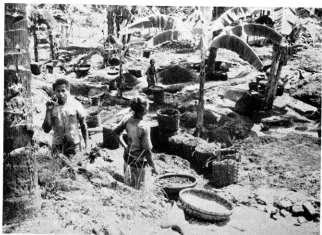
中部ジャワのクリリバン・マンガン鉱山の露天掘 住民がスコップで表土中に混ざった炭酸マンガンの小粒を ザルの中で水洗いして集めている
