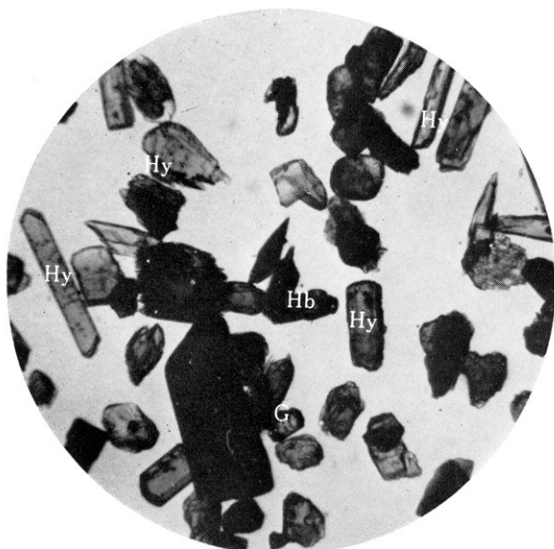
② 奈井江試錐の重鉱物(深度177m) ×60 Hy:紫蘇輝石 Hb:角閃石 G:ざくろ石
