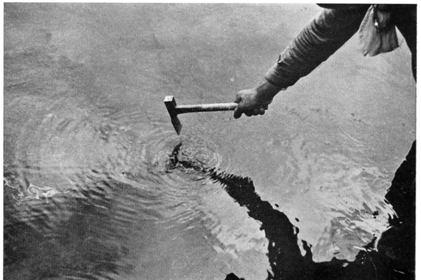
天北油田地区大曲背斜のガス徴(川の中) このガス徴は油と共に噴き出し写真の左に見えるのは油膜である
