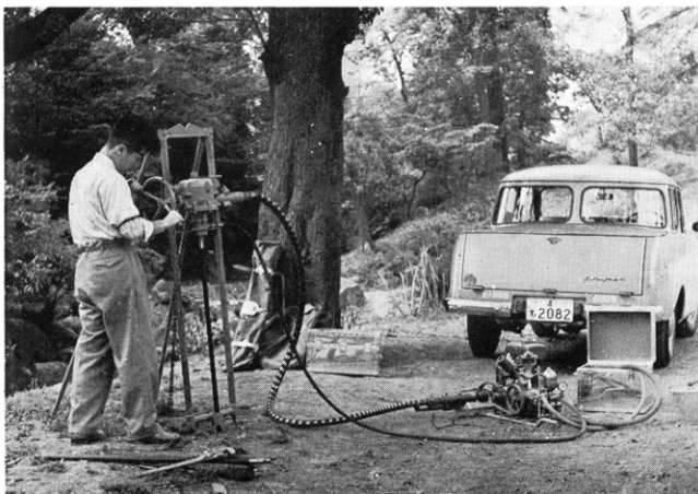
携帯用小形HS試錐機(国産) 動力3HPで掘進能力30m 本体の重量17kg 回転数200~400 r.p.m.
