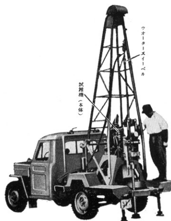
ジープ搭載の高速回転用UD-5型試錐機(国産) 動力 7.5HP 掘進能力 150m 回転数 250~ 500~1,000 r.p.m. 本体の重量 440kg
