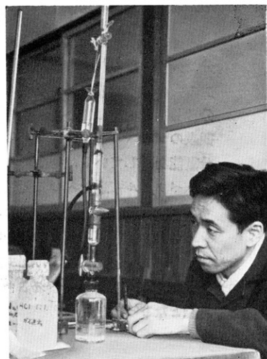
坑内水中の溶存メタンガス量の測定
