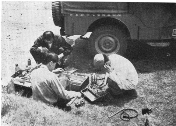
採取水試料の現場分析と水比抵抗の測定
