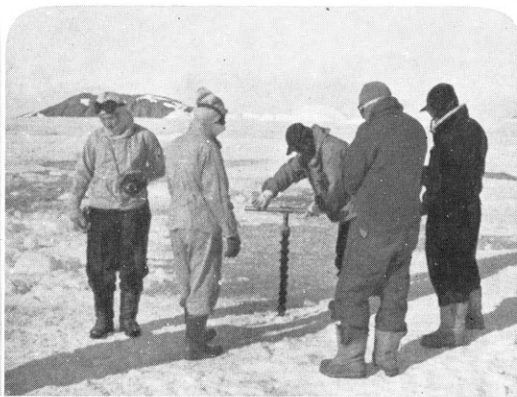
氷の厚さを測る 上の氷 15cm 水 60cm 下の氷 1.5m と測定された
