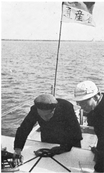
六分儀で測った測定位置を三桿分度儀で測板上にプロットする
