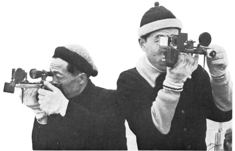
六分儀で重力測定位置の測角
