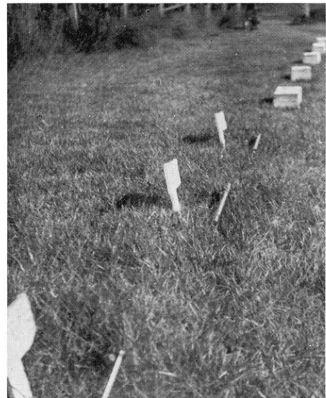
露場における地温測定施設 写真の手前は曲管寒暖計 後方打込みパイプに蓋がしてある 0.05, 0.1, 0.2, 0.3, 0.4, 0.5, 1, 2, 3, 5m と深度毎に1本ずつならんでいる
