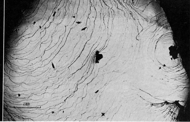
異種物質が存在したとき層のひろがりに及ぼす影響 不純物が存在した場合それを中心として 急速に layer がひろがり多角形の小さな突起(黒い小斑点)をつくり 更にこの突起がダムとなつて 基体結晶上の層のひろがりが影響をうけ扇状地状の模様ができる (嵯峨島産)
